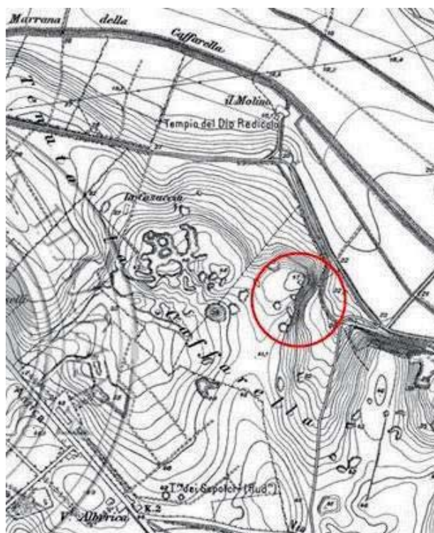
Fig. 23 – Stralcio topografico di un settore della bassa Valle dell'Almone. Sono presenti numerose forme "pseudo-carsiche", che costituiscono l'espressione superficiale di fenomeni di sprofondamento ( sinkhole ) legati al crollo di cavità antropiche sotterranee. L'evoluzione del fenomeno può arrivare ad interessare i versanti determinando il crollo di blocchi (cerchio rosso) (modificato, da IGM, 1924).
